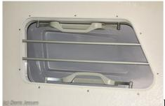
Für gute Durchlüftung sorgen die beiden fünffach klappbaren Fenster, die leicht getönt und aus Sicherheitsgründen vergittert sind.
