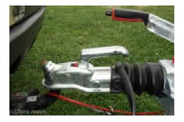
Das gesamte Handling rund ums Ankuppeln an das Zugfahrzeug läuft wie geschmiert. Die Zugkugelkupplung rastet schnell ein und sobald der Kugelkopf korrekt sitzt, wird dies durch die Sicherheitsanzeige grün markiert. Das Automatikstützrad ist leicht zu kurbeln und aufgrund seines langen Hubes darf das Rad auf weichem Grasboden gerne ein wenig einsinken. Die Handbremse lässt sich leicht anziehen und wieder lösen.
