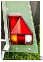
Die Beleuchtungskörper sind in geschlossene Heckstreben aus Stahl eingelassen, an denen sich weder Hufe noch Stricke verfangen können.
